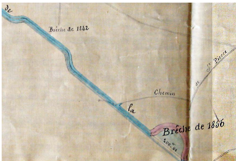
2 e détail : en haut, la brèche datée de 1842 et en bas celle dite du fer à cheval, près du chemin de Barrallier, de 200 m de large, avec une fosse profonde, décrite encore en eau.
